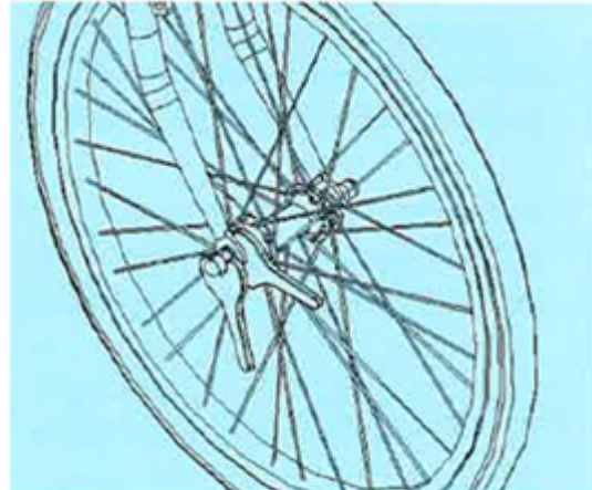
Figuur 3: Het voorwiel. Hier is te zien hoe de moer wordt vastgedraaid. Door aan de ene zijde de moer tegen te houden en aan de andere zijde de moer vast te draaien.
